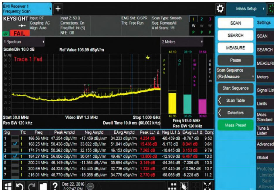
Рис. 4. Использование приложения для измерения ЭМП для анализаторов
