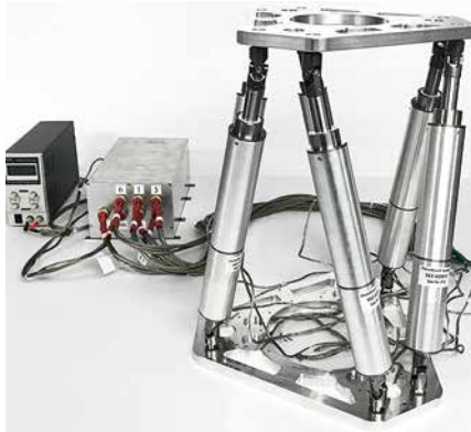
Мехатронное устройство высокоточного пространственного позиционирования «Гексапод»
