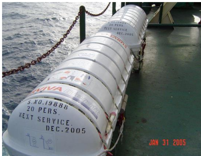
Рисунок 15.16 - Контейнеры для хранения надувных спасательных плотов
