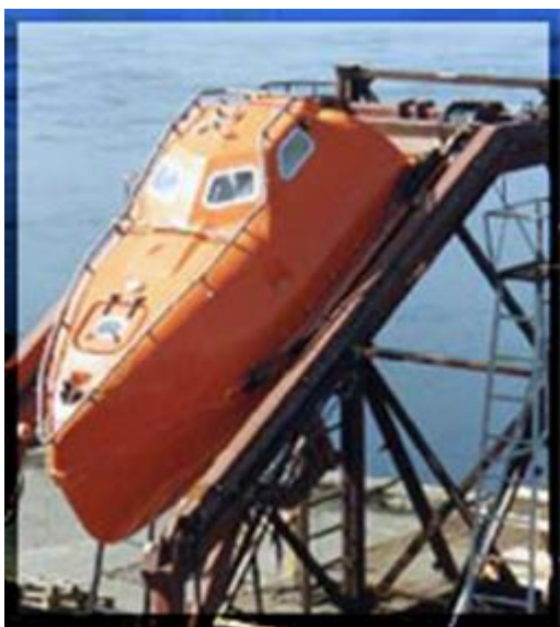
Рисунок 15.7 - Шлюпка, спускаемая свободным падением
